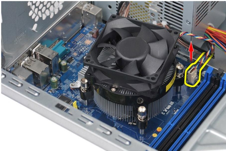
4. À l'aide d'un tournevis cruciforme, desserrez les quatre vis imperdables qui fixent le bloc ventilateur-dissipateur de chaleur à la carte système.
